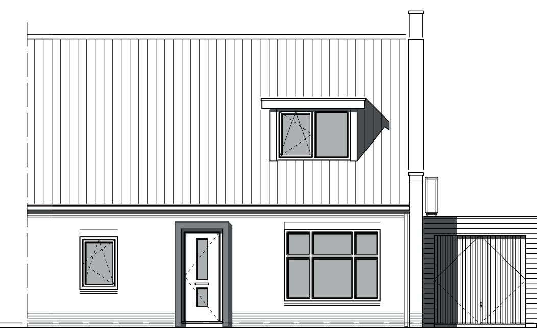
optie dakkapel slaapkamer 2 voorgevel
